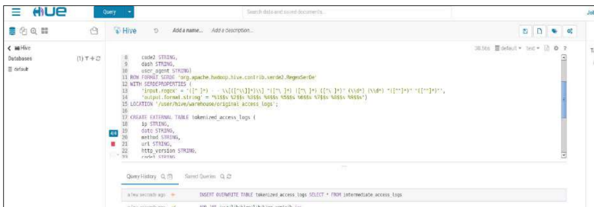
Figura 36. Transferencia de datos de una tabla a otra en paralelo con Hive
